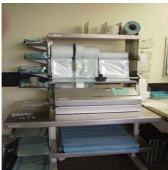
Малюнок 18. Приклад робочої станції для термогерметизації
