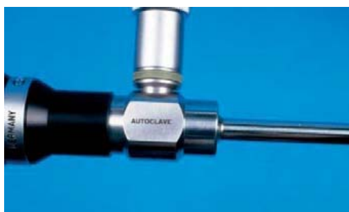
Рисунок 22. Приклад ендоскопа з печаткою виробника, що засвідчує, що його можна стерилізувати в автоклаві
